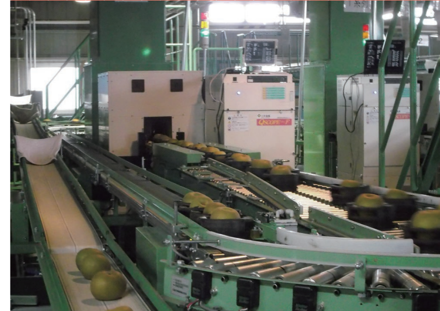
↓光センサーで「甘さ」「酸味」「色」「傷み」「重量」などの検査を行い、出荷等級に反映させ、厳選出荷を行っています
