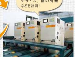
「光センサー選果機」を導入し、糖度・酸度・外観とともに基準をクリアしたものだけを出荷しています。
