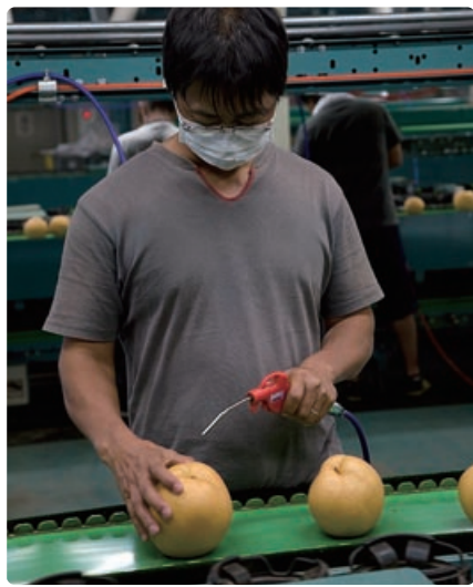
↑台湾に輸出される梨(新高)を、害虫が混入しないようにエアークリーンしているところ
